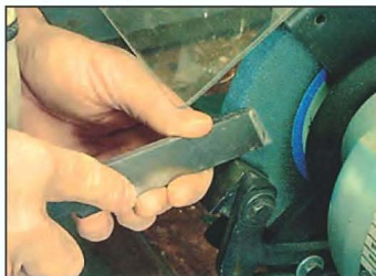
2-6. При необходимости переточить косую стамеску можно на боковой стороне шлифовального круга толщиной не менее 25 мм. Работать нужно в защитных очках.
