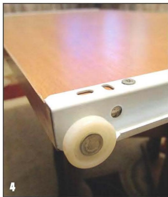
3 На боковинах и кромках панели под клавиатуру смонтировали элементы выдвижного механизма.
