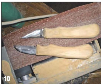
Рукоятки после грубой обработки.
