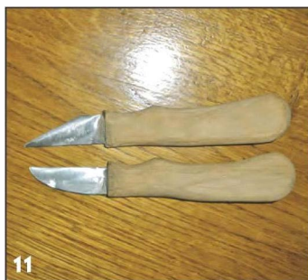
Рукоятки обработаны мелкой шлифовальной шкуркой и подготовлены для нанесения лака.
