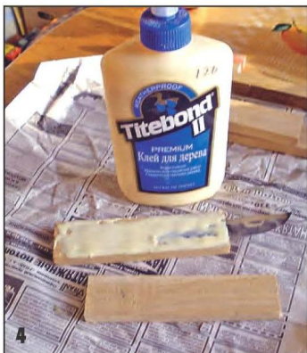
Клей нанесён и на склеиваемую поверхность детали рукоятки, и хвостовик в гнезде. Чтобы не испачкать клеём столешницу, проще всего застелить её газетой.
