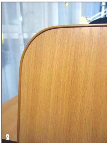
2 Кромки столешницы оклеены кантом U16.
