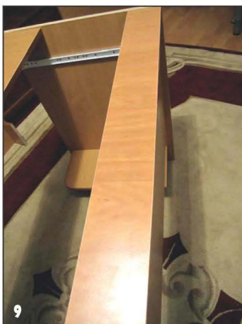
Боковины столика соединены задней стенкой и верхними горизонтальными связями.
