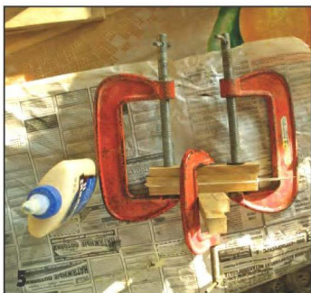
При склеивании рукоятки детали стянуты струбцинами.
