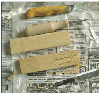
В половинке будущей рукоятки стамесками выбрано гнездо для хвостовика.
