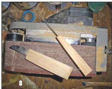
Первый этап обработки рукояток — обтачивание на ленточной шлифовальной машинке.
