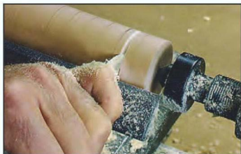
Рис. 5-1. Обработку начинают от середины размеченного кольца. Медленно поднимают ручку «веретена» и в середине будущей выкружки протачивают неглубокую ложбинку.
