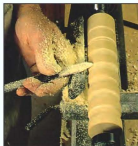
Рис. 5-2. Затем протачивают сверху правую сторону выкружки и ведут обработку вниз по ложбинке.
