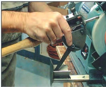
2-4. Установив в карман подручника специальное приспособление, перетачивают грубо заточенную стамеску «веретено». Форма режущей кромки будет похожа на обводы крупного лайнера.
