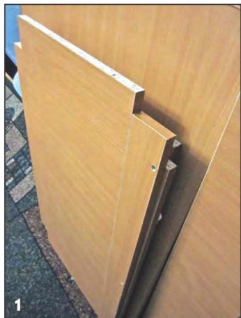
1 В деталях по разметке просверлены отверстия под конфирматы.
