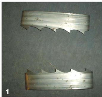
В качестве заготовки для изготовления клинков ножей использовал полотно ленточной пилы.
