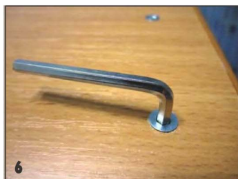
Детали компьютерного стола надёжно соединили конфирматами.
