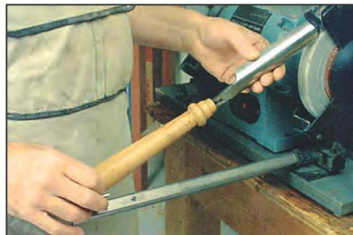
2-1. Ручку обдирочной стамески упирают в карман подручника и, прижав режущую кромку к шлифовальному кругу, вращают стамеску то по часовой стрелке, то против.
