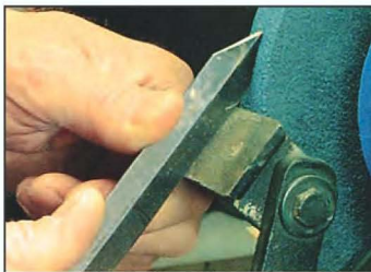
2-5. Поднутрённой V-образной отрезной стамеской работать лучше. Для заточки стамески нужен круг Ø150 или Ø200 мм.
